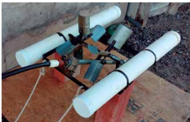
Bomba de rebalse modificada para generar una carga hidráulica.
