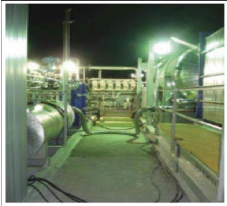
Equipos de tratamiento de agua contaminada por *fracking* en el Marcellu Shale; fuente: Onsite Water Treatment (2006)
