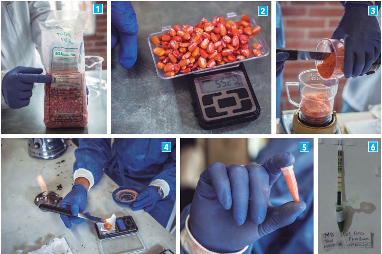
Secuencia del procedimiento para realización de las pruebas para determinar presencia de eventos transgénicos en semillas de maíz. 1. Identificación de la muestra. 2. Pesado de la muestra. 3. Maseración de la muestra. 4. Pesado de la muestra a evaluar. 5. Dilución de la muestra con la solución Buffer. 6. Aplicación de la tirilla correspondiente al evento a evaluar. Revelado del resultado.
