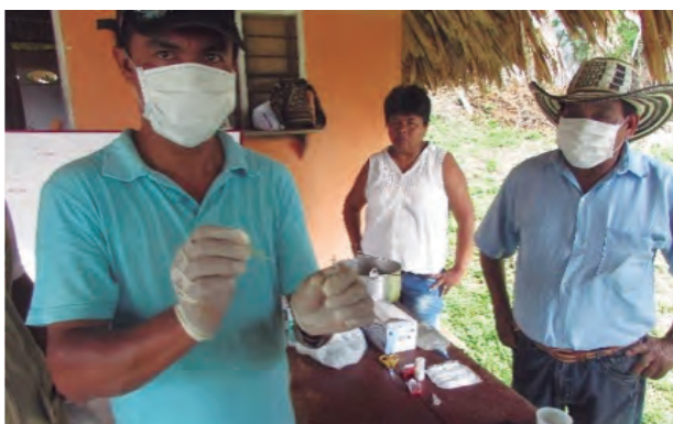
Aplicación de la tirilla que indica presencia de eventos GM, en la muestra de maíz a evaluar.
