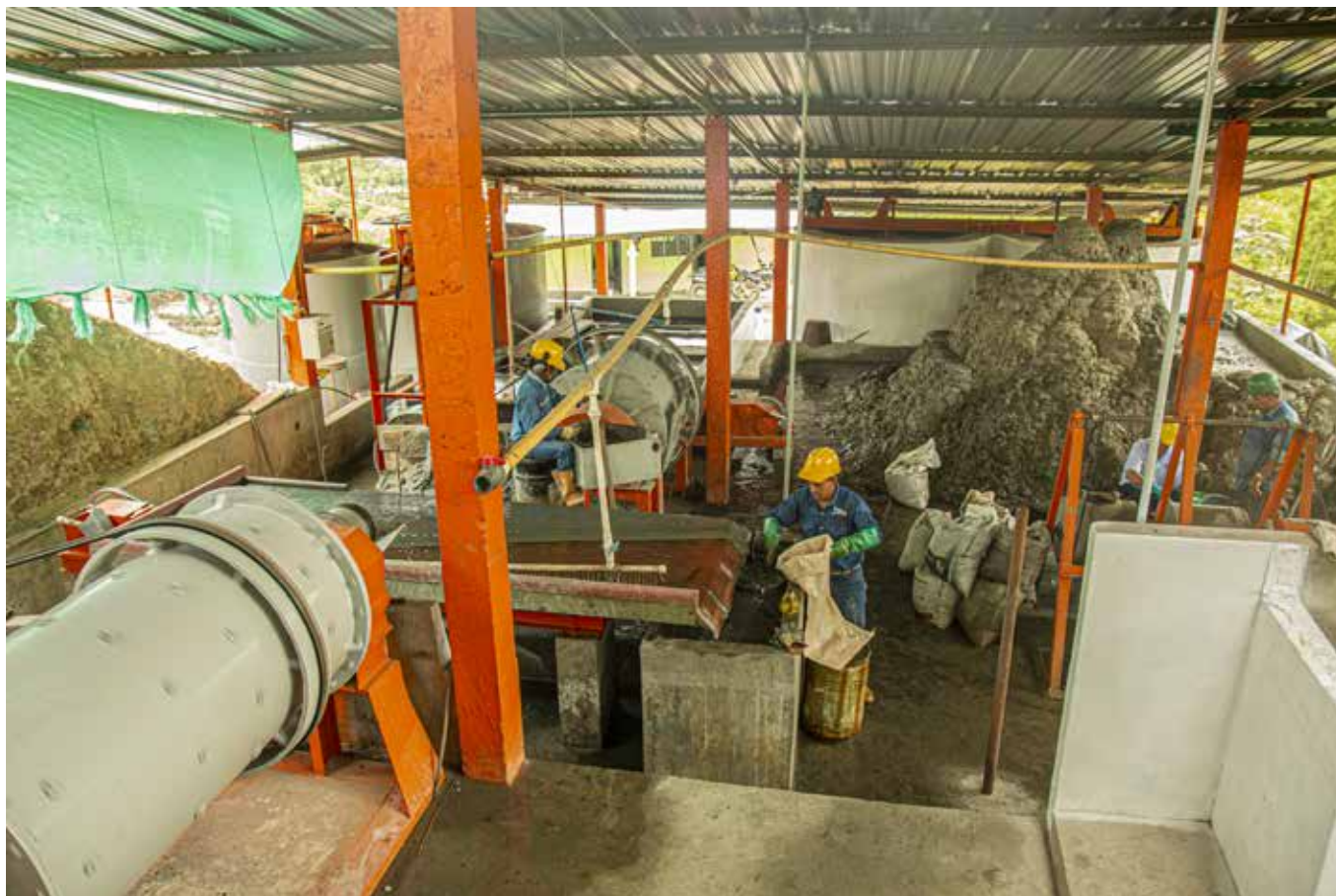
Proceso de transformación de rocas para separar el metal. El sitio no cuenta con los protocolos de seguridad para los mineros ni para los afluentes cercanos. Foto: Viviana Sánchez Prada
