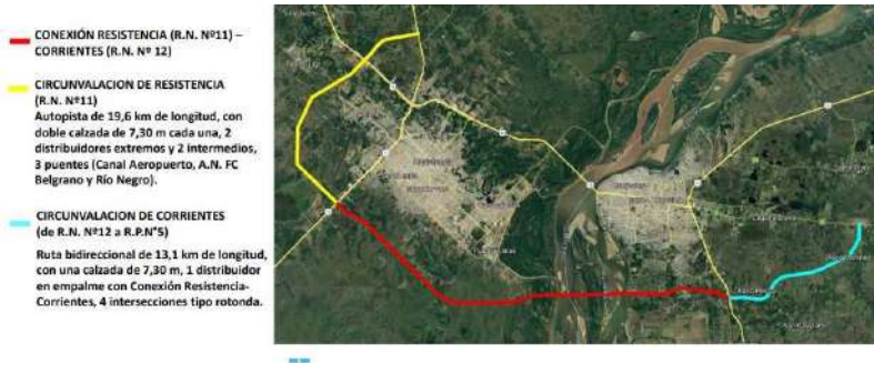
Imagen 3. Circunvalaciones de Resistencia y Corrientes
