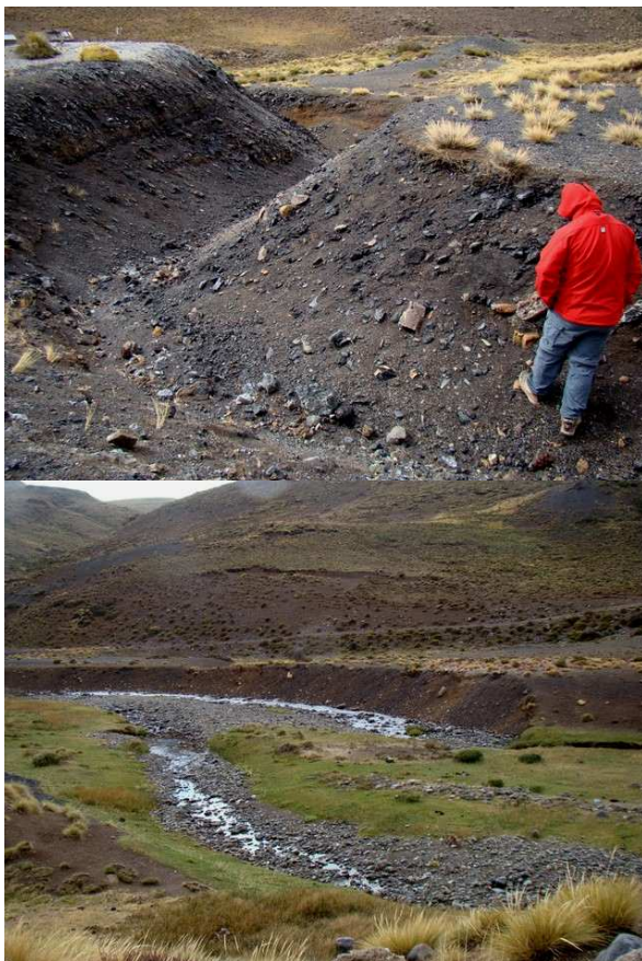
Las escombreras de la mina Pico Quemado se depositaron directamente sobre el cauce mismo de los cursos de agua. Si bien la naturaleza se ha encargado de restituir buena parte (no todo) del paisaje, estos enormes depósitos de mineral de baja ley a la intemperie y sin ningún tipo de aislación, a más de tres cuartos de siglo de haberse abandonado la mina, continúan produciendo drenajes ácidos que van a parar a los cursos de agua. Fotos: www.toyoteros.com.ar
